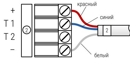
Подключение двух датчиков температуры
