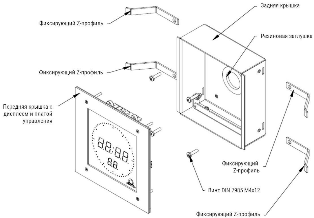
Модели DA.18...FP могут быть смонтированы в проёмы панелей без доступа сзади. Монтаж выполняется в следующем порядке:
