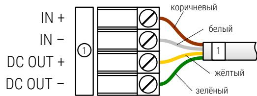
Подключение датчика температуры
