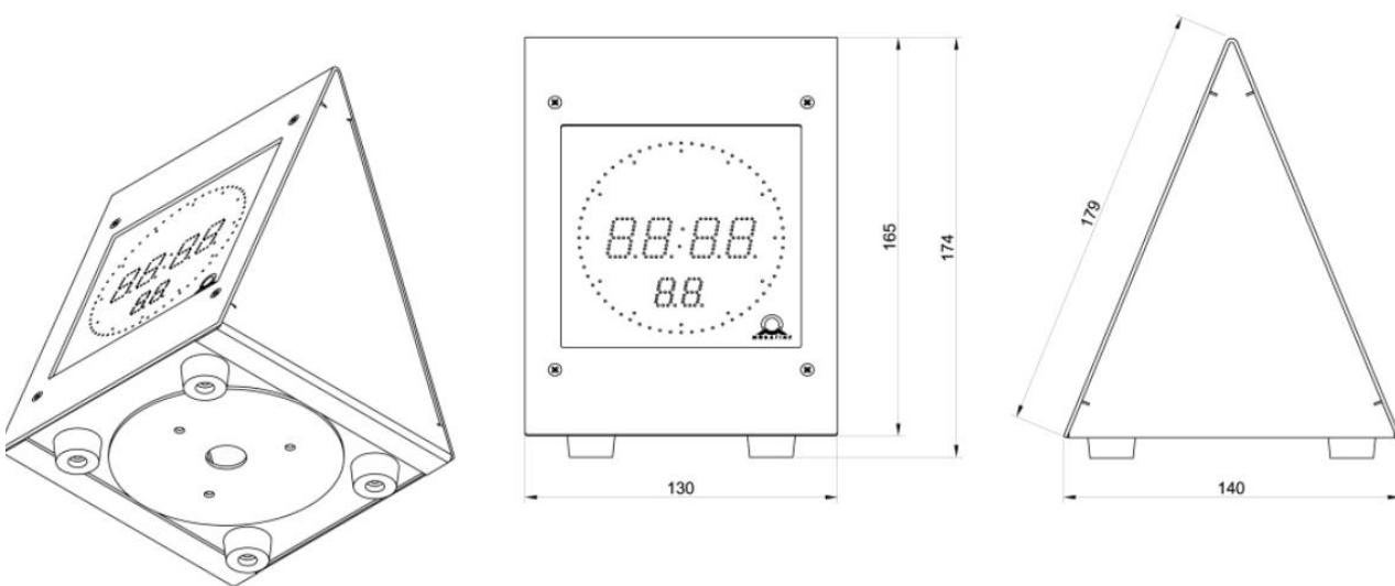
Настольные модели имеют 4 резиновых ножки на нижней поверхности корпуса и могут свободно располагаться на столе. При необходимости резиновые ножки могут быть удалены с корпуса, а задняя крышка зафиксирована на горизонтальной поверхности винтами через отверстия. Для этого:
