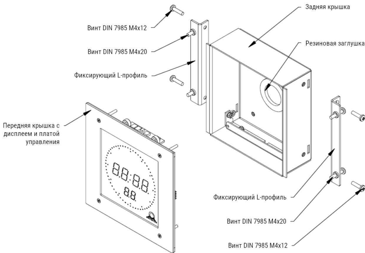
Модели DA.18...FP могут быть смонтированы в проёмы панелей с доступом сзади. Монтаж выполняется в следующем порядке:
